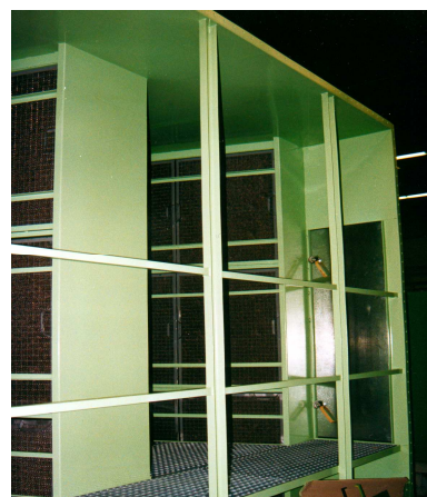
Abb. 2: Dunstabscheider KG in der Endkontrolle
