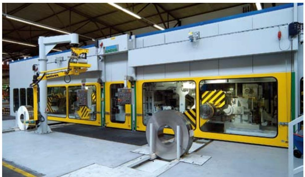
**Bild 3: Einhausung des 20-Rollen-Walzwerks**
