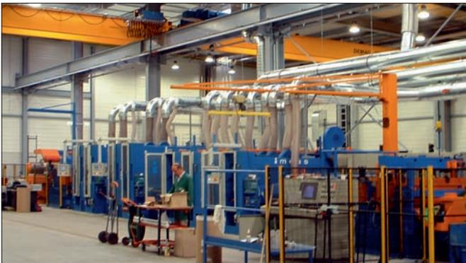
Abb. 3a: Anschlussseite Entstaubung – Coil-System
