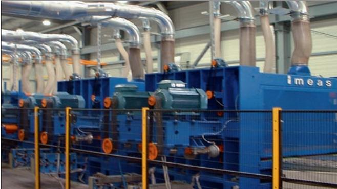
Abb. 1: Antriebsseite Coilschleifanlage
